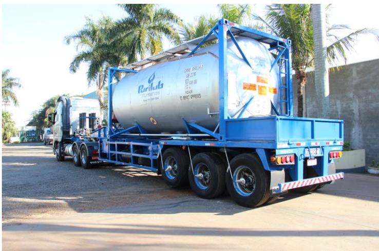
O movimento do veículo contribui para a homogeneização do óleo, o conjunto de filtros em série, com acionamento independente, reduz o grau de contaminação de óleos hidráulicos para o NAS desejado.
